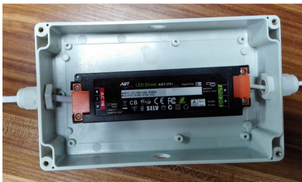
Drivdonet placerad i en IP65-klassad monteringsbox.
